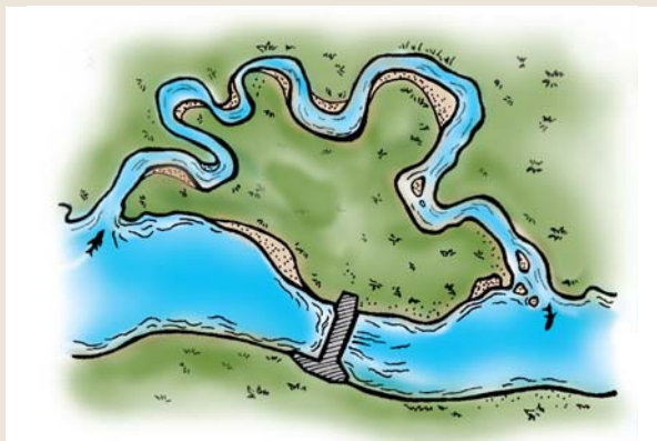
Megkerülő-csatornák: A vízi élőlények számára lehetőleg természetközeli kialakítású mellékágat létesítenek.
